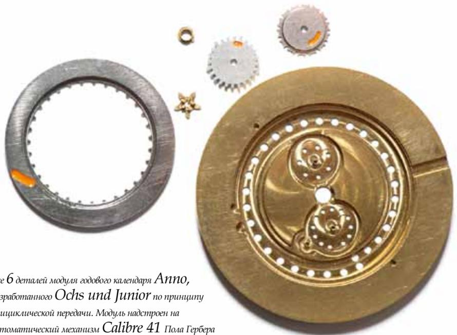
*Все 6 деталей модуля годового календаря Anno, разработанного Ochs und Junior по принципу эпициклической передачи. Модуль настроен на автоматический механизм Calibre 41 Пола Гербера*
