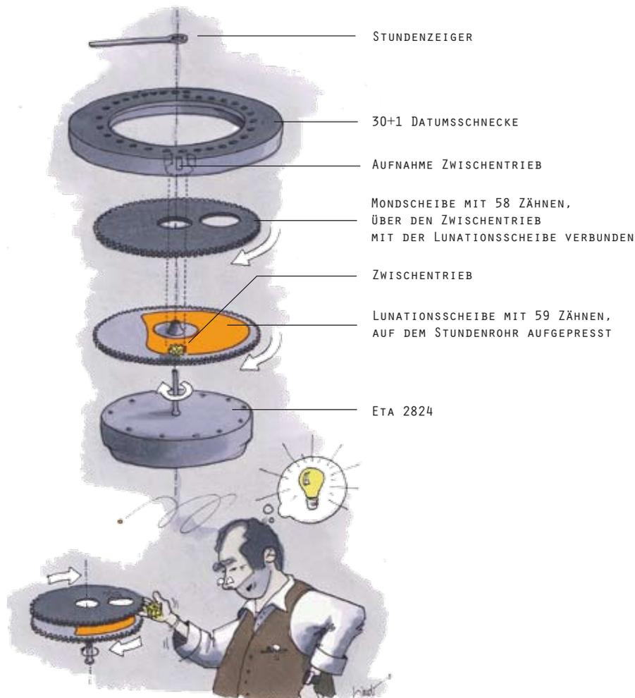
Oechslin realisiert diese romantische Innovation mit nur **vier funktionalen Teilen**. Getreu seiner Arbeitsweise, dass die beste Lösung immer die einfachste ist, lässt sich die Technik seiner Monduhr kinderleicht verstehen;
